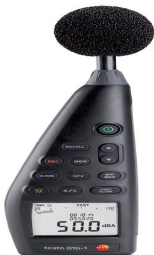
Figure 3: Sonomètre de marque Testo 816-1
